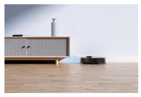
**Le capteur ToF** permet au robot de se réorienter lorsqu'il est face à un espace trop bas
